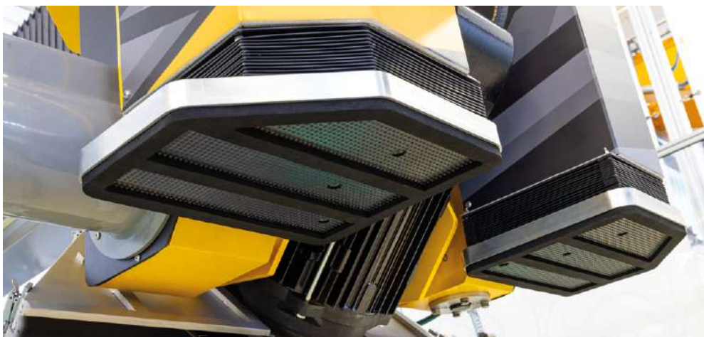
Vacuum lifter / Ventosa per taglio ottimizzato
